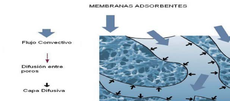
Figura 2.2. Vista parcial de las membranas Sartobind en la que se observan cómo ocurren los procesos de transferencia de masa por convección y difusión
