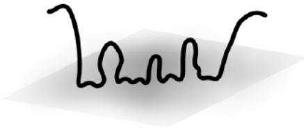
Figura 2.3. Representación esquemática de una molécula polimérica adsorbida a una superficie a través de múltiples sitios de unión.
