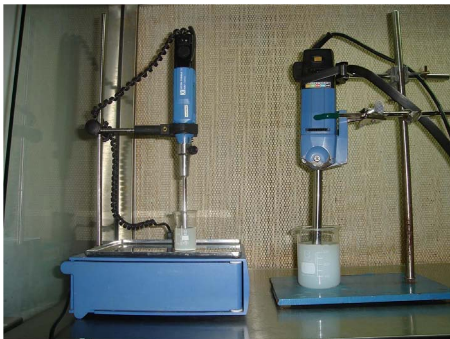
Figura A5.4. Las operaciones del proceso de encapsulación por el método de doble emulsión - evaporación del disolvente se llevan a cabo en un flujo laminar para garantizar la esterilidad de las microesferas obtenidas.
