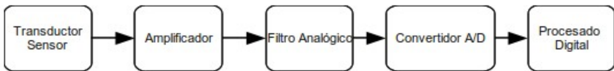
Figura 10: Diagrama de bloques de un sistema de adquisición de señales
