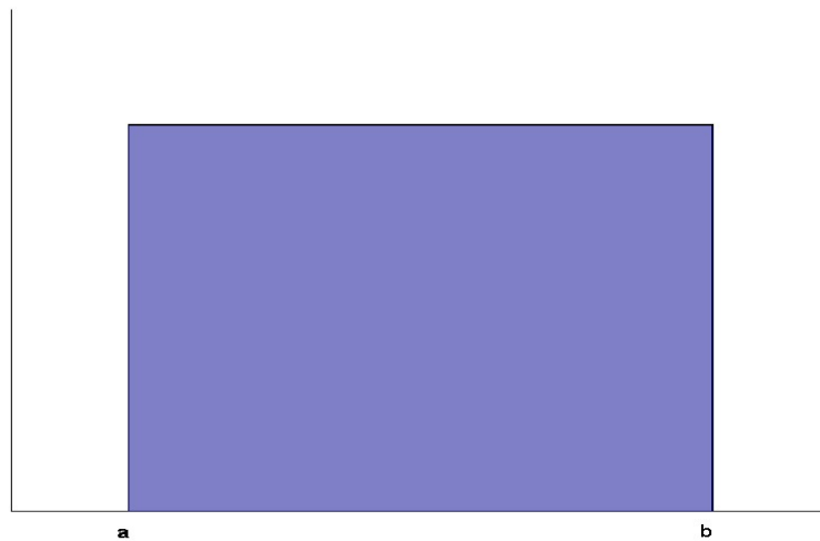
Figura 14: Función de densidad de probabilidad de una variable uniforme acotada en el intervalo [a, b]
