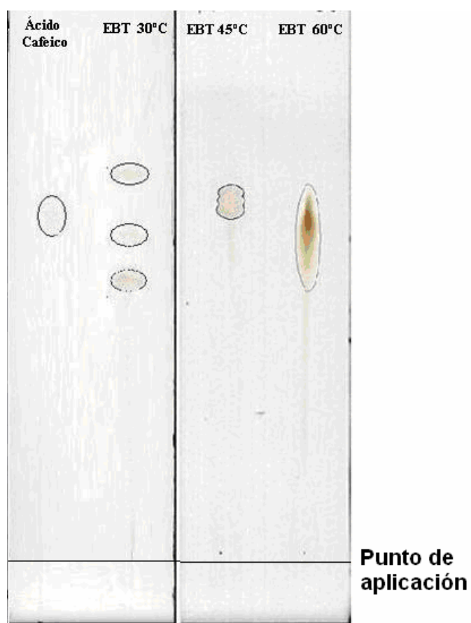
Figura 10. Cromatogramas del extracto blando de las hojas de tamarindo tratado individualmente a diferentes valores de temperatura por una semana. Soporte Sílica gel GF 254 , sistema de solvente: N-butanol: ácido acético: 2-propanol (4.2:4, v/v/v), tiempo de desarrollo 2.5 horas, revelador luz UV 254 nm.
